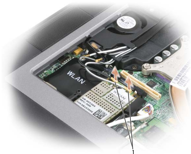
1 Cables de antena
