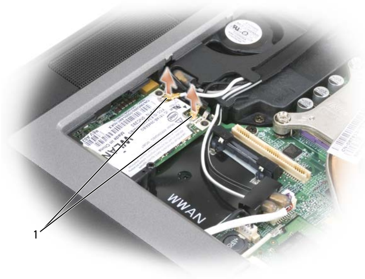
1 Cables de antena
